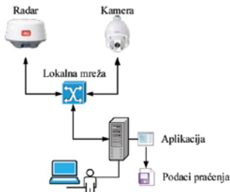
**Sl 7:** Ilustracija sustava za demonstraciju praćenja cilja radarski male refleksijske površine.
