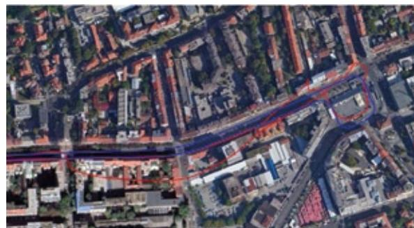
**Sl 5:** Putanja tramvaja prilikom zaokreta oko Kvaternikovog trga. Crvena putanja prikazuje rezultat iz IMU i GPS uređaja, dok je plava rezultat algoritma fuzije s vizualno inercijalnom odometrijom
