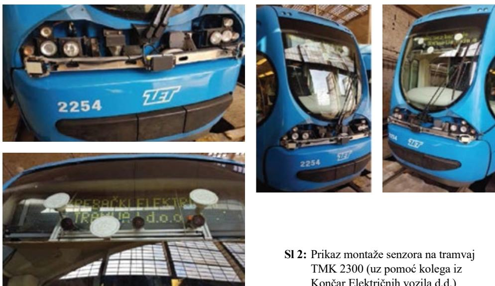
**SI 2:** Prikaz montaže senzora na tramvaj TMK 2300 (uz pomoć kolega iz Končar Električnih vozila d.d.)
