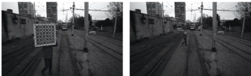
Slika 4: Primjer umjeravanja kamera (lijevo) te radara i kamere
