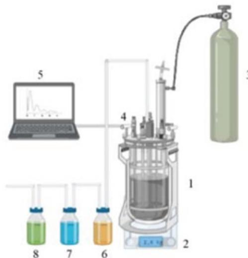
Sl 3: Shematski prikaz reaktorskog sustava za kompostiranje biorazgradivog otpada:
